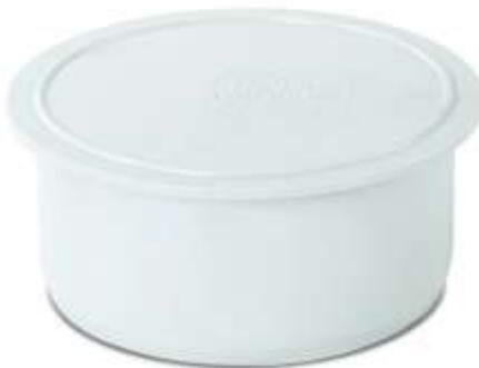
جهت استفاده از انتهای مسیر لوله کشی فاضلاب به طور موقت و یا دائم، همچنین پس از نصب لوله کشی فاضلاب ساختمان ها برای تستهای مربوطه و همچنین به عنوان درپوش جهت جلوگیری از ورود اشیا و مصالح ساختمانی به داخل شبکه ساخت و ساز استفاده می‌گردد.
